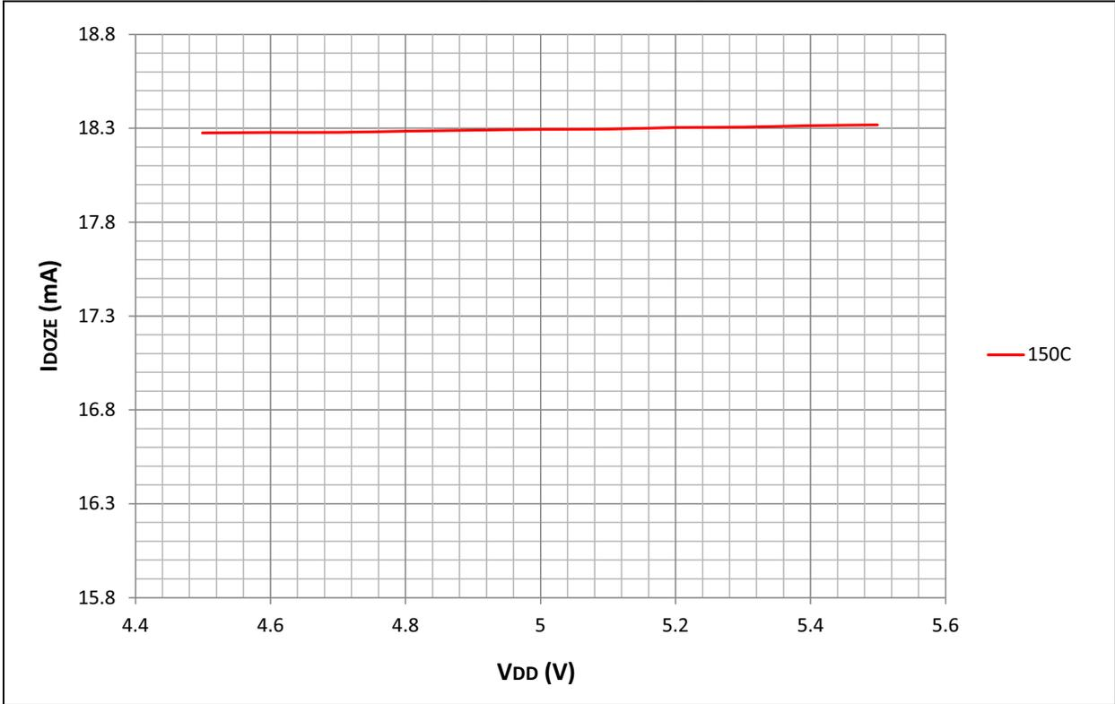
FIGURE 33-10: TYPICAL/MAXIMUM IDOZE vs. TEMPERATURE (DOZE 1:2, 70 MIPS)
