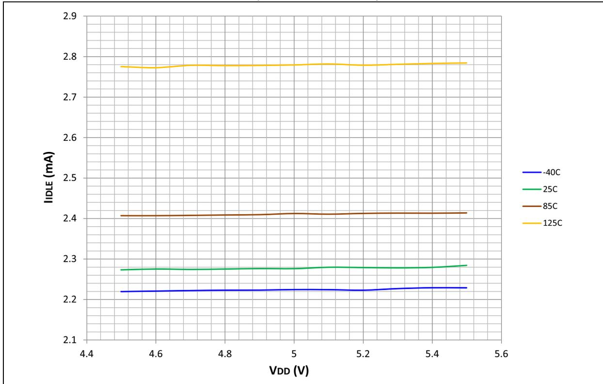
FIGURE 32-10: TYPICAL I<sub>IDLE</sub> vs. V<sub>DD</sub> (EC MODE, 40 MIPS)
