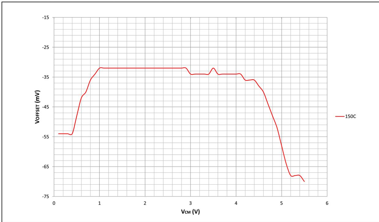
FIGURE 33-34: TYPICAL OP AMP OFFSET vs.  $V_{CM}$
