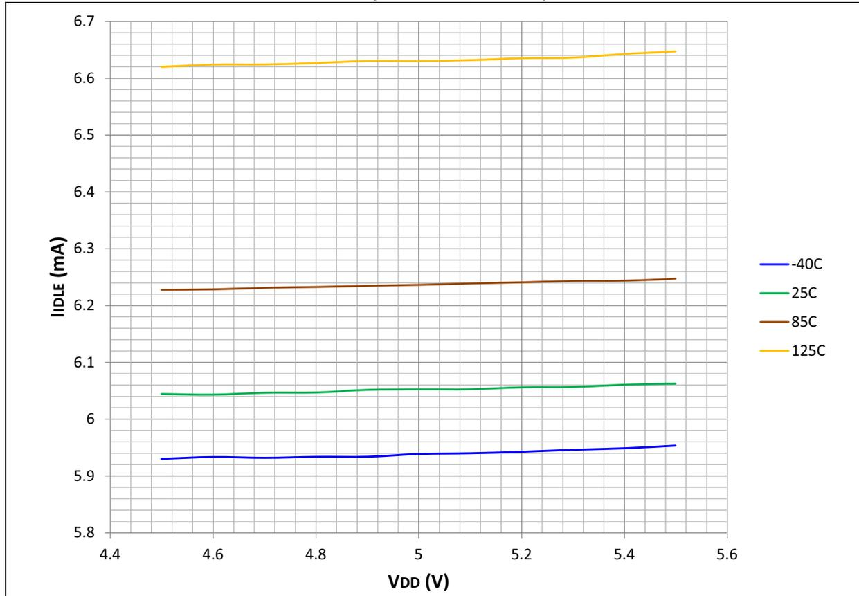
FIGURE 32-12: TYPICAL I<sub>IDLE</sub> vs. V<sub>DD</sub> (EC MODE, 70 MIPS)
