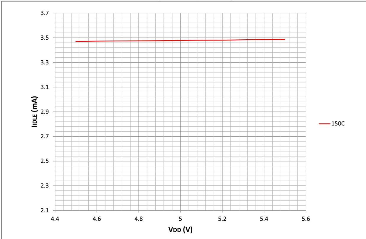
FIGURE 33-8: TYPICAL I<sub>IDLE</sub> vs. V<sub>DD</sub> (EC MODE, 40 MIPS)
