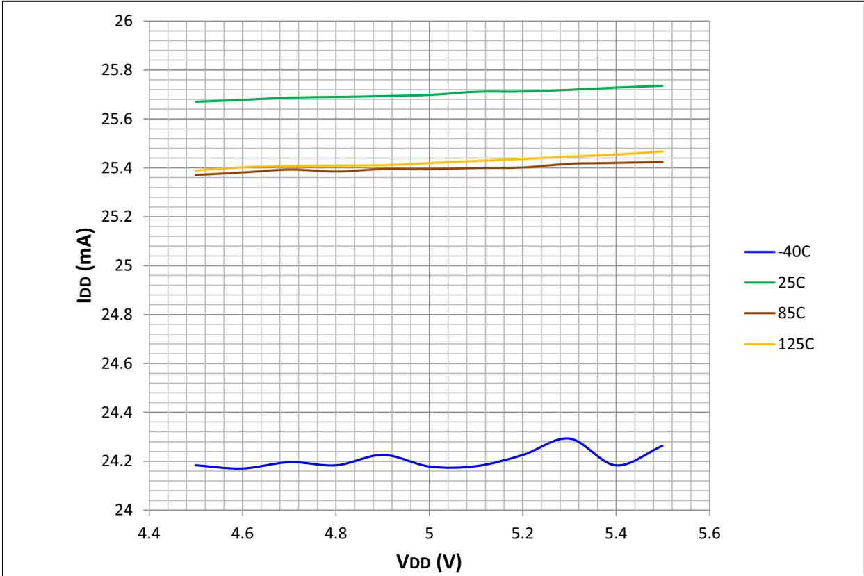
FIGURE 32-6: TYPICAL I<sub>DD</sub> vs. V<sub>DD</sub> (EC MODE, 70 MIPS)
