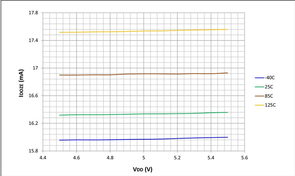
FIGURE 32-14: TYPICAL/MAXIMUM IDOZE vs. TEMPERATURE (DOZE 1:2, 70 MIPS)
