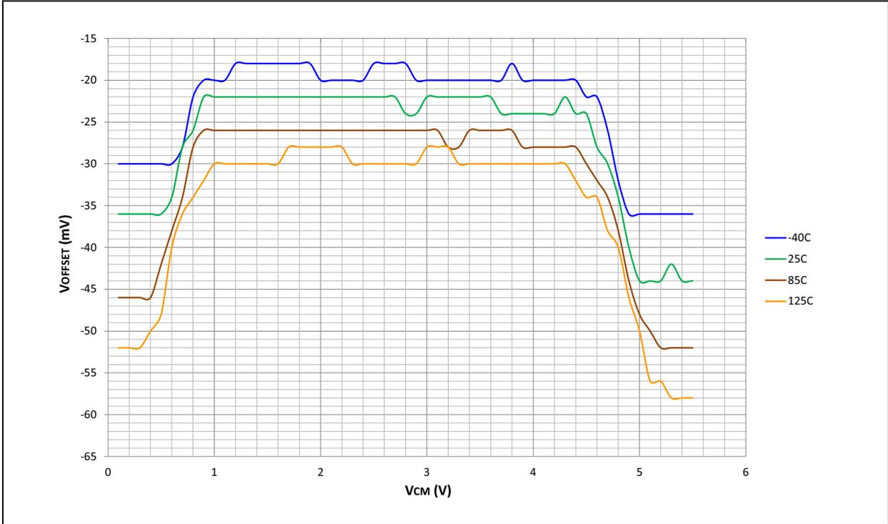
FIGURE 32-38: TYPICAL OP AMP OFFSET vs.  $V_{CM}$  OP AMP OFFSET
