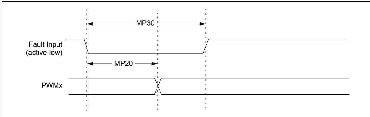
**FIGURE 30-11: HIGH-SPEED PWMx MODULE TIMING CHARACTERISTICS**
