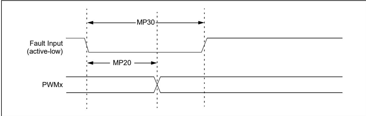
**FIGURE 33-6: HIGH-SPEED PWMx MODULE TIMING CHARACTERISTICS**
