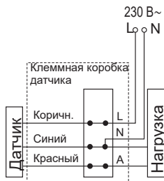
Рисунок 31 – Схема подключения датчиков типов ДД 022 (LDD11-022-2000-001), ДД 023 (LDD10-023-2000-K01)
