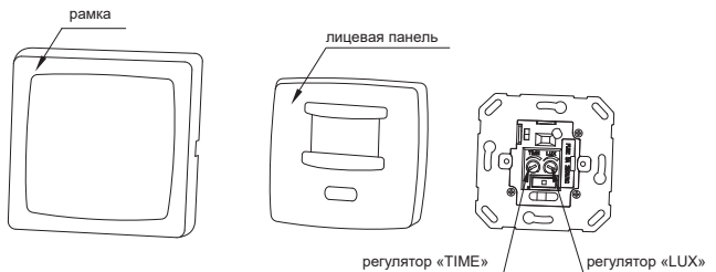
Рисунок 14 – Конструкция датчика движения ДД 030
