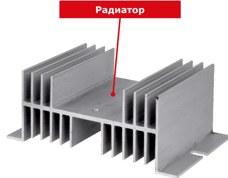
При температуре основания ТТР выше 40 °С происходит снижение их коммутационной способности. Для предотвращения этого ТТР устанавливают на радиатор. Радиаторы подбираются по номинальному току нагрузки. Реле на радиатор устанавливаются с использованием термопасты.
