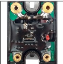
Компаунд обеспечивает дополнительную защиту от влаги, пыли и перегрева
