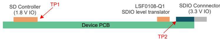
图 11-2. Device Placement
