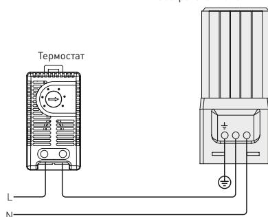
Монтаж и подключение обогревателя должны осуществляться квалифицированным электротехническим персоналом. Монтаж на 35 мм DIN-рейку. Для защиты от перегрева необходимо подключение через термостат.
