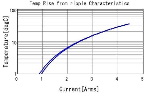
GRM188D71A475KE11 Temp. rise ■ 500kHz ■ 1MHz
