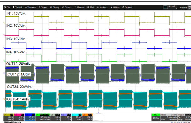
图 8-7. 步进电机全步运行
