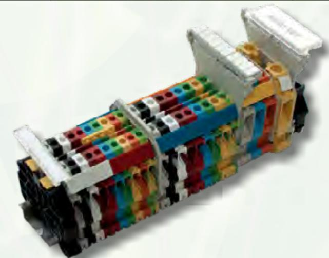
Клеммы шириной 10 мм (номинальное сечение проводников 10 мм<sup>2</sup>), 12 мм (номинальное сечение проводников 16 мм<sup>2</sup>) и 16 мм (номинальное сечение проводников 35 мм<sup>2</sup>) маркируются шильдиками для клемм шириной 5 мм, 6 мм и 8 мм соответственно, с маркировкой, нанесенной «через один» шильдик. Шильдики поставляются в полосках по 10 шт. для маркировки клемного блока из 5 клемм.
