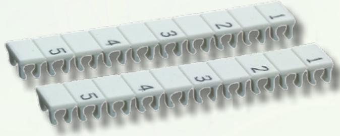
Установка маркировочных шильдиков на клеммы шириной 10 мм (10 мм<sup>2</sup>), 12 мм (16 мм<sup>2</sup>), 16 мм (35 мм<sup>2</sup>). Маркировка наносится «через один» шильдик
