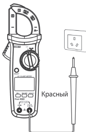
Рис. 6 Определение нуля и фазы
