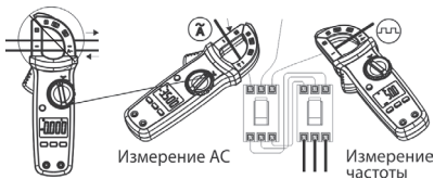
Рис. 2 Измерение силы и частоты переменного тока
